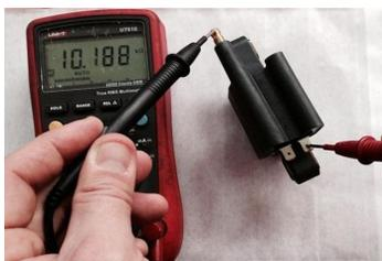
Sulle bobine con doppia uscita la resistenza del circuito secondario si misura toccando con i puntali le due uscite per i cavi candela
