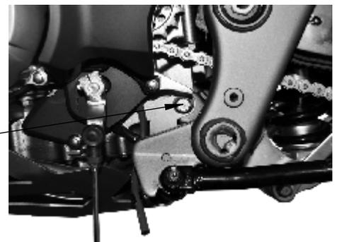
Motorschutzblech Pos. 2 gem. Explosionszeichnung an die bereits montierten Haltebügel anschrauben. Der Zusammenbau erfolgt in umgekehrter Reihenfolge!
