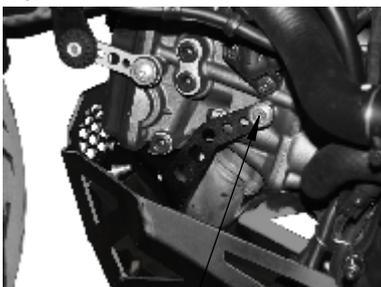
Haltebügel gemäß der Explosionszeichnung & den mitgelieferten Befestigungsmaterial am Motor montieren!
