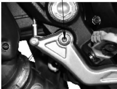
Schraube entfernen & Distanzhülse Pos.: 2.8 einsetzen. Originalschraube durch Pos.: 2.9 ersetzen und den Haltebügel gemäß der Explosionszeichnung montieren!
