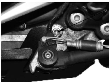
Originalschraube entnehmen & mit Pos. 2.8 ersetzen. Den Haltebügel mit der mitgelieferten Distanzbuchse und Unterlegscheibe gemäß der Explosionszeichnung montieren!
