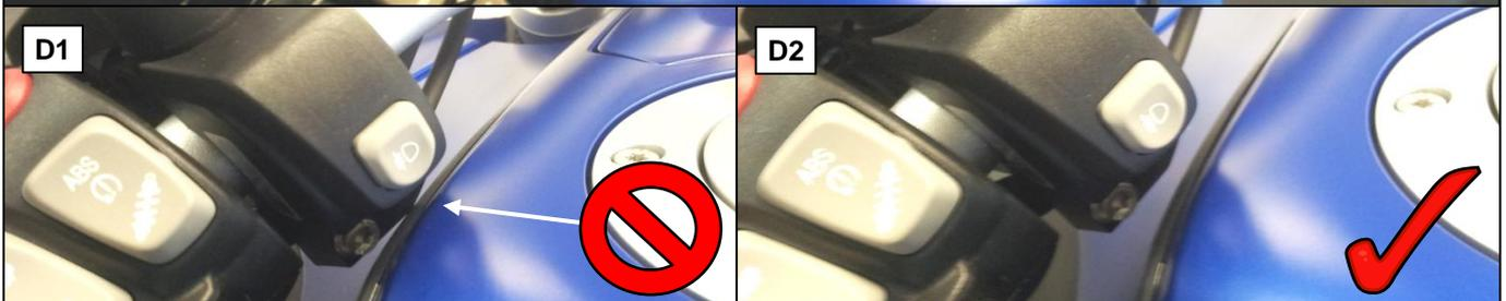
**D:** Prüfen Sie den Anbau auf Kollisionen zum Tank/ Kanzelverkleidung und die generelle Freigängigkeit durch vorsichtiges Einschlagen des Lenkers vom rechten zum linken Lenkansschlag!
