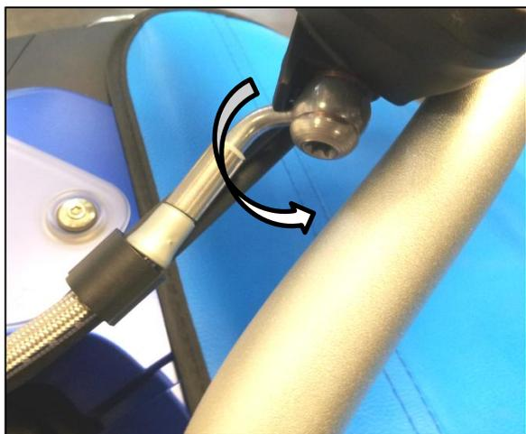
**Hinweis/ Tipp:** Falls Sie zusätzlichen Freigang beim Einlenken des Lenkers (Von Anschlag zu Anschlag) an der Brems- bzw. Kupplungsleitung benötigen, können optional die Fittings der Leitungen an den Hydraulikpumpen verdreht werden. Bei vorsichtigem öffnen der Hohlsschraube muss der Kreislauf auch nicht entlüftet werden.
