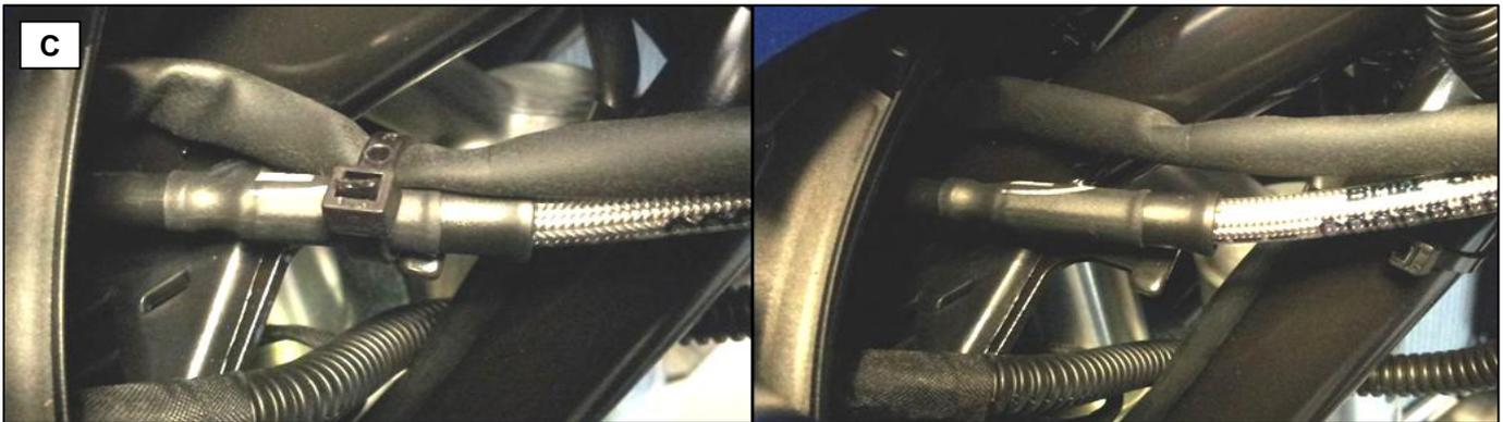
**C:** Entfernen Sie den Kabelbinder (rechts vom Lenkkopf) um Spannung von der originalen Bremsleitung zu nehmen und zusätzliche Freigängigkeit zu generieren.
