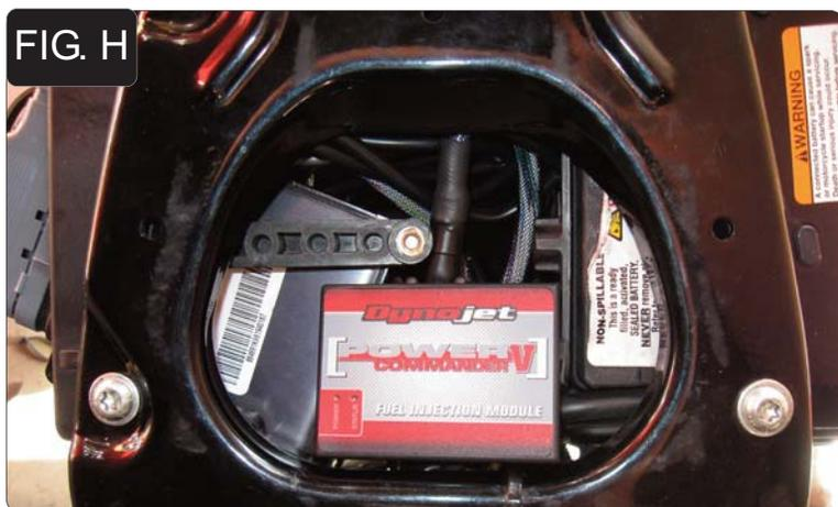
17. Posizionare il PCV nell'apertura del telaio che si trova sotto la sella. E' possibile utilizzare il velcro oppure le fascette fornite per fissare l'unità PCV.
