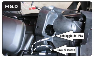
5. Far scorrere il cablaggio del PCV attraverso la copertura in gomma come mostrato in Fig. D.
