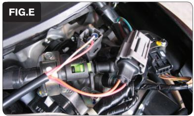
6. Collegare il cablaggio del PCV in linea con l'iniettore ed il cablaggio originali (Fig. E).
