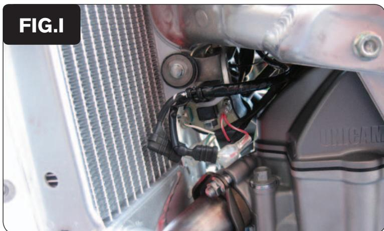
10. Collegare il PCV in linea con la bobina ed il cablaggio originali (Fig- I).
