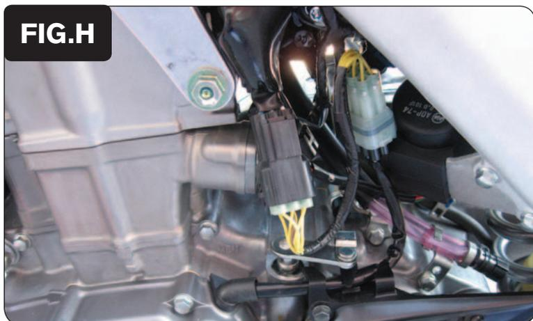
9. Collegare il PCV in linea con il sensore pick-up ed il cablaggio originali (Fig. H).
