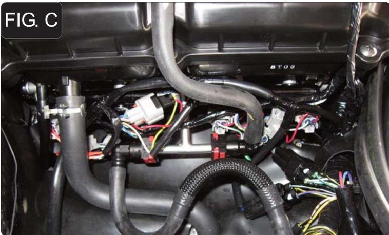
6. Collegare il PCV in linea con il cablaggio originale e gli iniettori (Fig. C).
