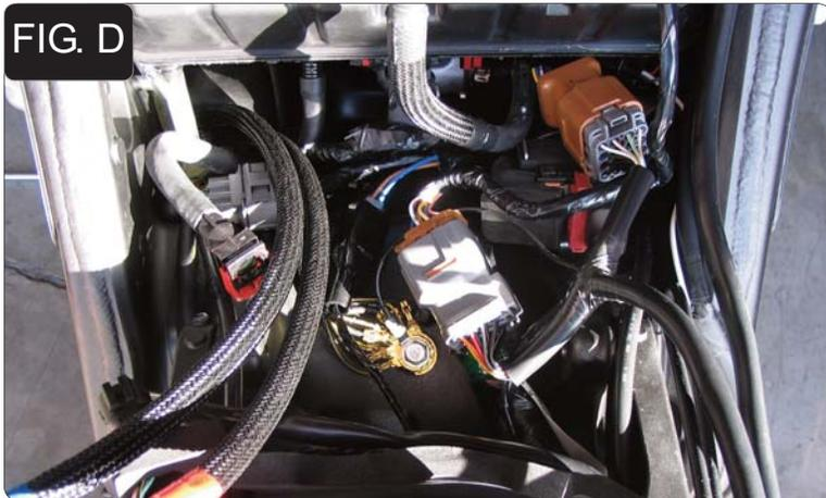
7. Collegare il PCV in linea con il cablaggio originale ed il corpo farfallato (Fig. D).
