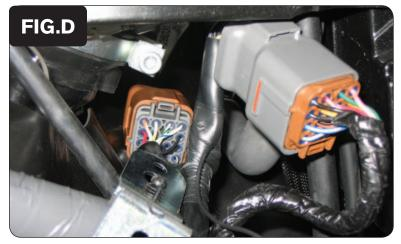
5. Collegare il PCV in linea con il cablaggio del corpo farfallato ed il cablaggio originale (Fig. D).
