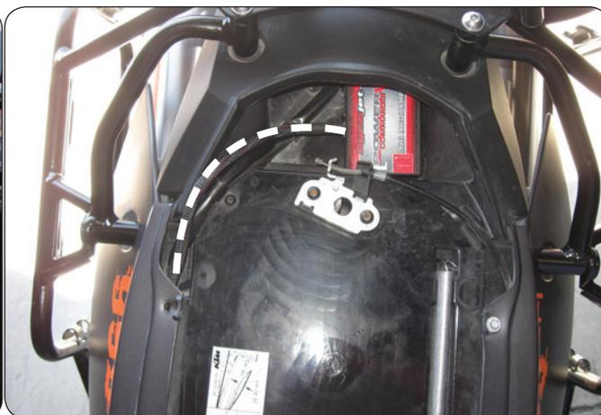
4. Rimuovere le 3 viti del codino posteriore sul lato destro della moto (Fig.C).
