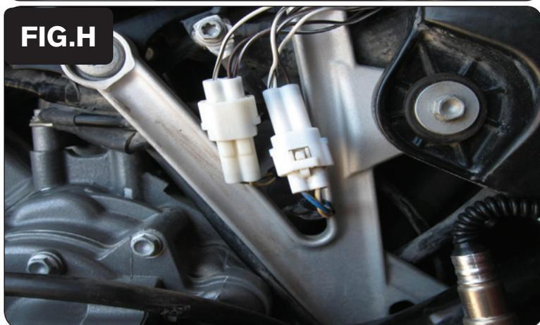
11. Collegare i connettori BIANCHI del PCV in linea con il connettore del sensore pick-up albero motore ed il cablaggio originali (Fig. H).
