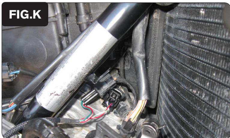
14. Collegare i connettori del PCV con filo VERDE in linea con la bobina di accensione del cilindro anteriore ed il cablaggio originali (Fig. K).
