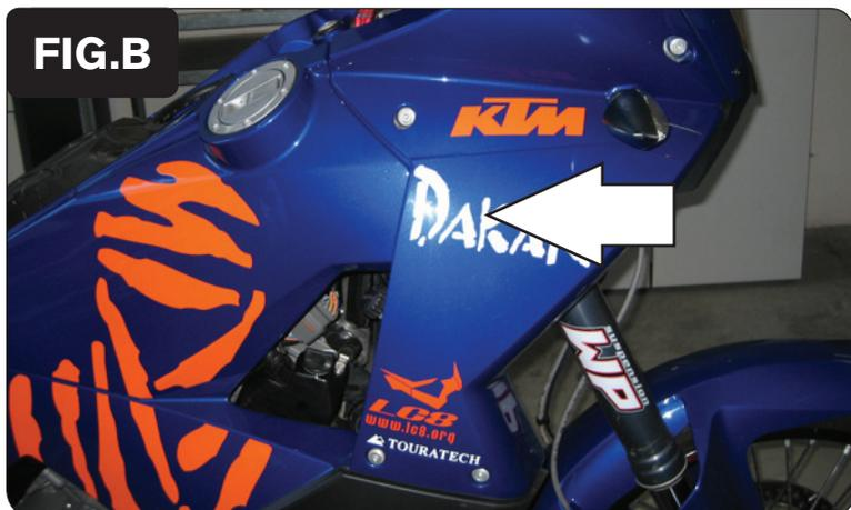
3. Rimuovere le carrozzerie laterali e i serbatoi benzina (Fig.B).
