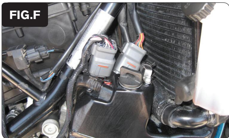
9. Collegare il PCV in linea con il sub-connettore dei corpi farfallati ed il cablaggio originali (Fig.F).
