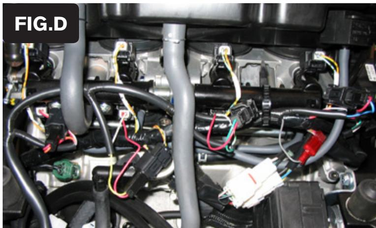
7. Collegare il PCV in linea con il cablaggio originale e gli iniettori INFERIORI (Fig. D).
