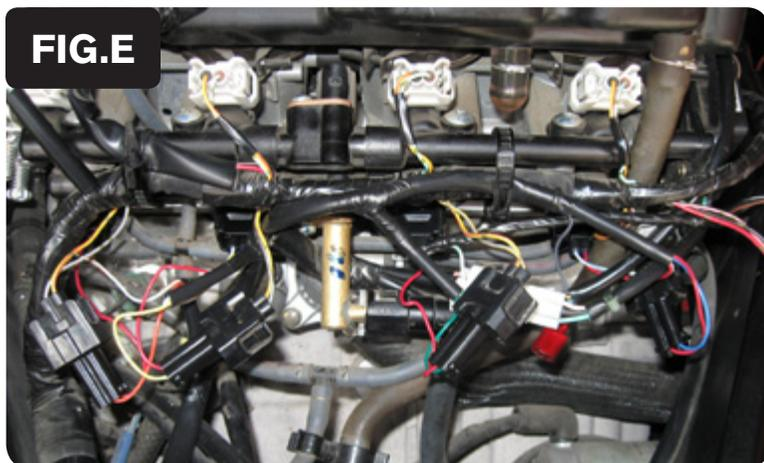
9. Collegare il PCV in linea con il cablaggio originale e gli iniettori INFERIORI (Fig. E)
