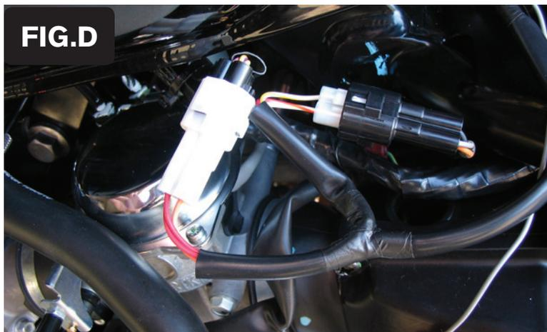
8. Collegare il PCV in linea con il connettore ed il cablaggio originali (Fig. D).
