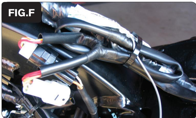
11. Fissare il cablaggio del PCV al cablaggio principale della moto utilizzando una fascetta in plastica (Fig. F)
