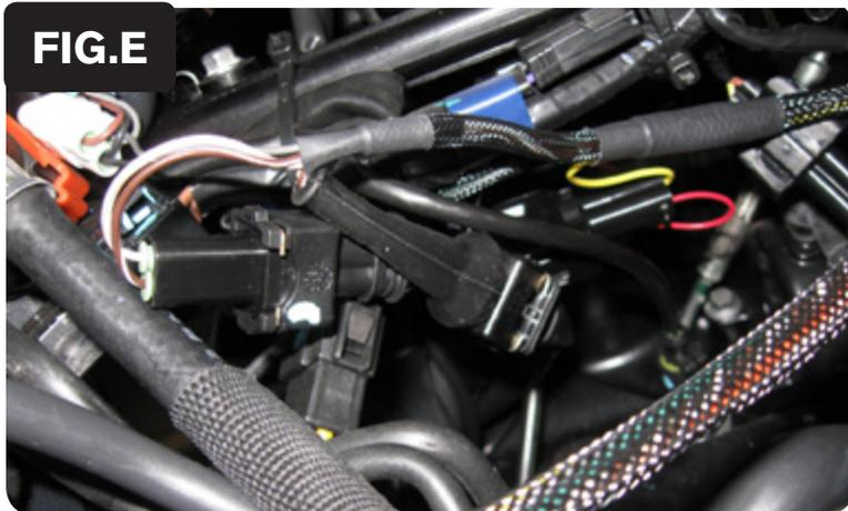
11. Collegare il PCV in linea con il cablaggio originale e il connettore pick-up albero motore(Fig. E).
