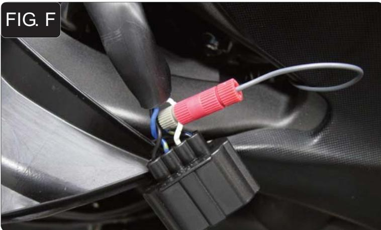
9. Utilizzando il morsetto Posi-Tap fornito collegare il filo GRIGIO del PCV al filo di colore BIANCO del cablaggio del TPS (Fig. F).
