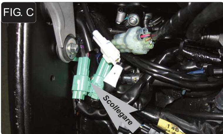
6. Scollegare il connettore del corpo farfallato dal cablaggio principale (Fig. B).
