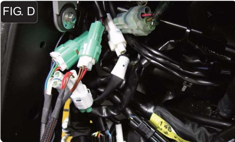
7. Collegare i connettori del PCV in linea con il connettore ed il cablaggio originali (Fig. D).
