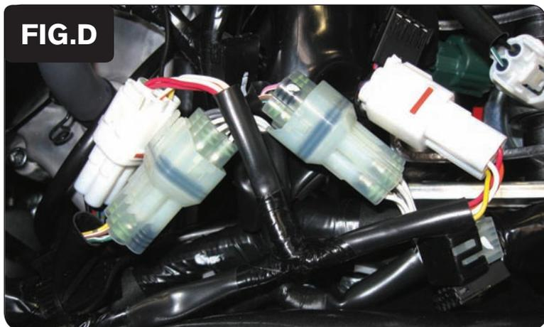
6. Collegare i connettore del PCV in linea con i connettori originali BIANCO e TRASPARENTE (Fig. C).
