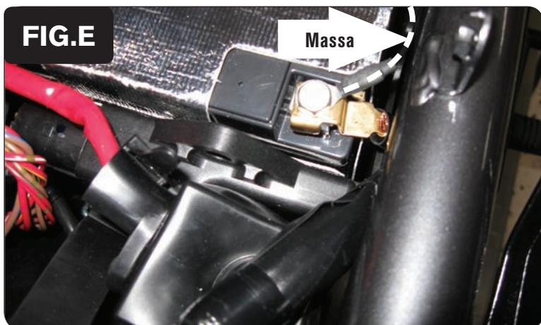
7. Collegare il cavo di massa al terminale negativo della batteria(Fig. E).
