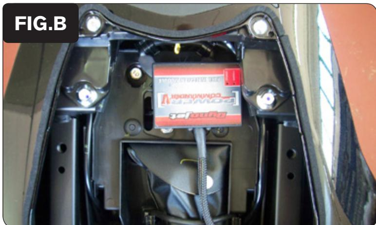
3. Fissare il PCV nell'area sottosella utilizzando la striscia di velcro presente nel kit.
