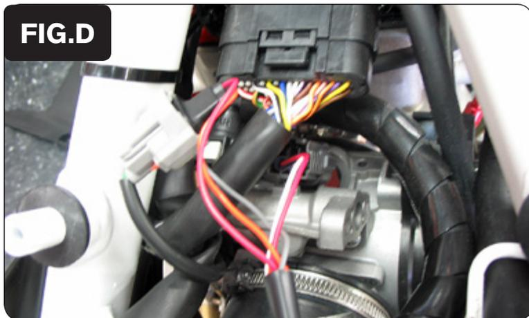
7. Collegare i connettori del PCV in linea con il connettore e l'iniettore originali (Fig. D)
