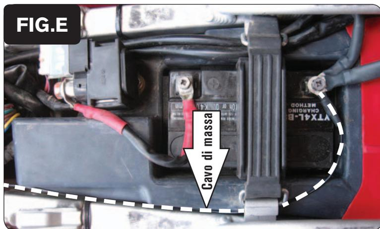
10. Collegare il cavo di massa dal PCV al terminale negativo (-) della batteria (Fig.E).
