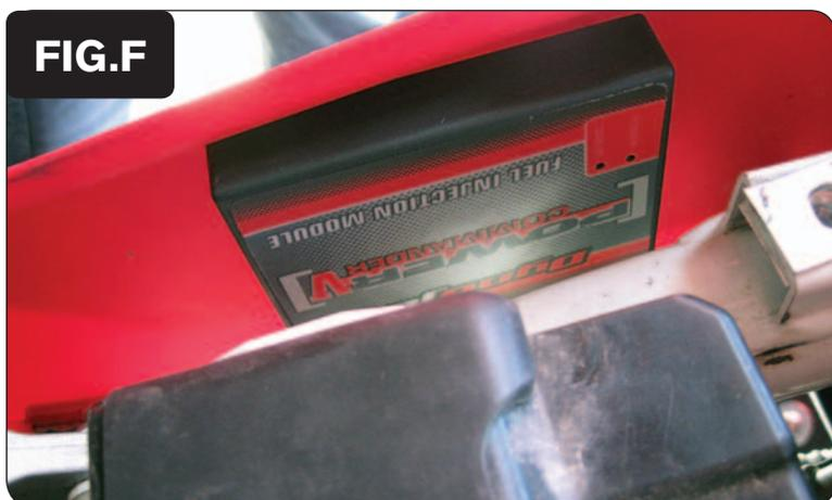
11. Utilizzando la striscia di velcro fornita fissare il PCV all' interno del convogliatore radiatore sinistro (Fig. F).
