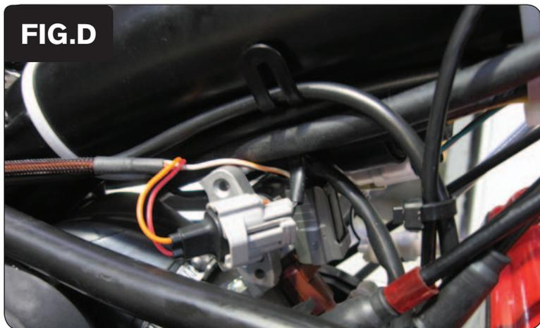
7. Collegare il cablaggio del PCV in linea con l' iniettore ed il cablaggio originali (Fig. D).
