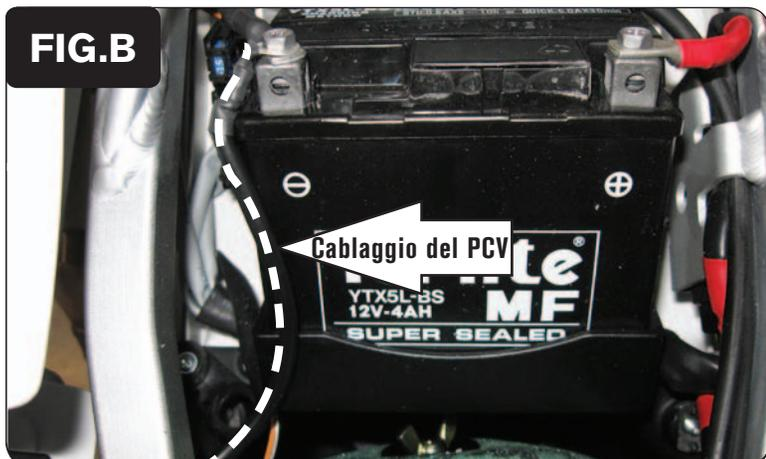
4. Collegare il cavo di massa dal PCV al terminale negativo (-) della batteria (Fig.B).
