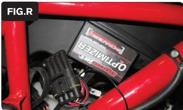
27. Fissare l'optimizer lambda sul lato destro dell'airbox utilizzando la striscia di velcro fornita (Fig. R).
