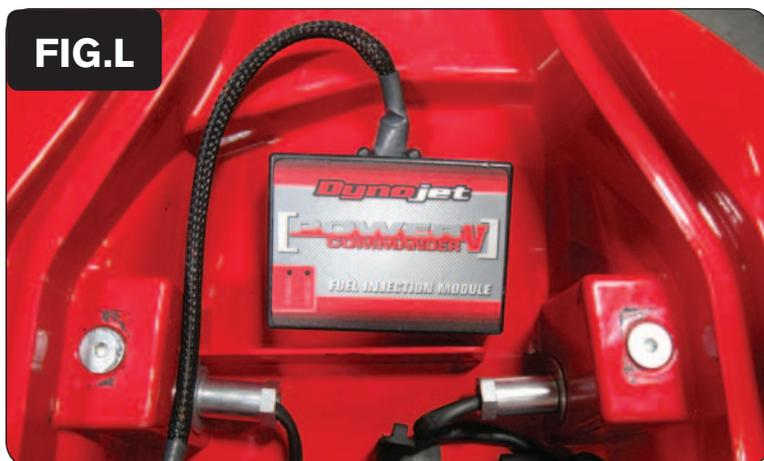
20. Fissare il PCV nell'area sottosella utilizzando il velcro fornito. Pulire accuratamente entrambe le superfici con la salvietta in alcool fornita prima di applicare la parte adesiva del velcro.
