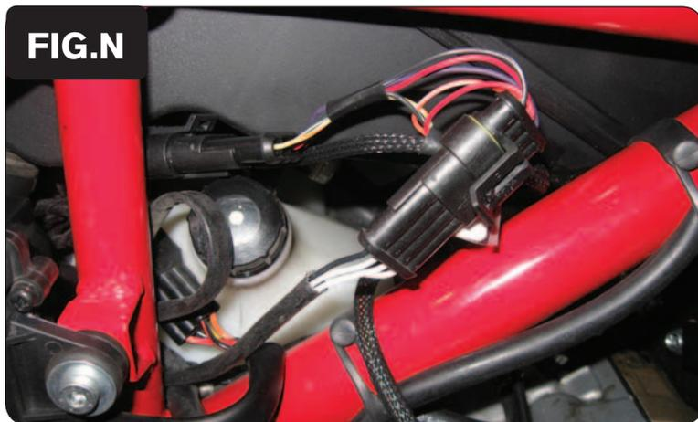
22. Scollegare la sonda lambda del cilindro Anteriore dal cablaggio della moto e collegare i connettori dell'optimizer lambda con l'etichetta FRONT in linea con il cablaggio originale e la sonda lambda del cilindro Anteriore (Fig. N).
