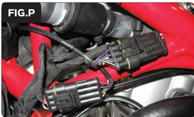
25. Scollegare la sonda lambda del cilindro Posteriore dal cablaggio della moto e collegare i connettori dell'optimizer lambda con l'etichetta REAR in linea con il cablaggio originale e la sonda lambda del cilindro Posteriore (Fig. P).
