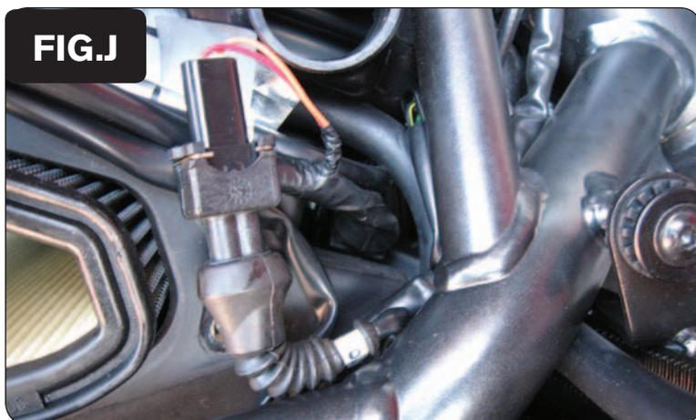
11. Collegare i connettori del PCV con i fili di colore ARANCIONE in linea con il cablaggio originale e l'iniettore del cilindro anteriore (Fig. J).
